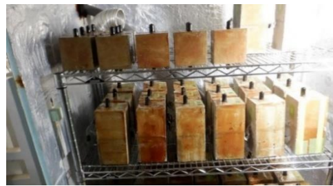
写真-3 乾湿繰返し試験の様子
