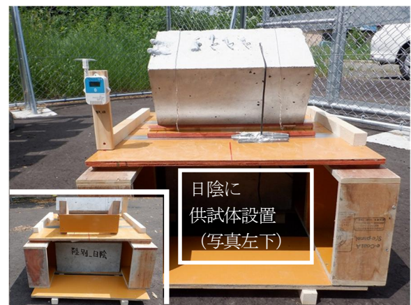
写真-3 陸別町小利別・温湿度計埋設供試体設置
