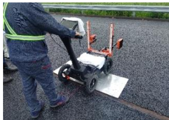
写真4 転圧毎の締固め度測定
