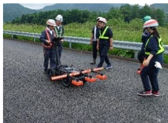
写真5 面的な締固め度測定
