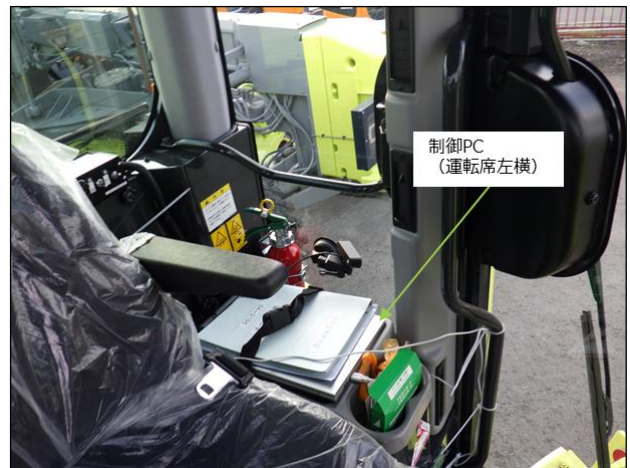
図-9 除雪グレーダ 制御PC設置場所
