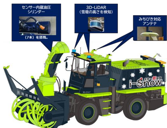
図-4 除雪装置自動制御付ICTロータリ除雪車 搭載機器説明
