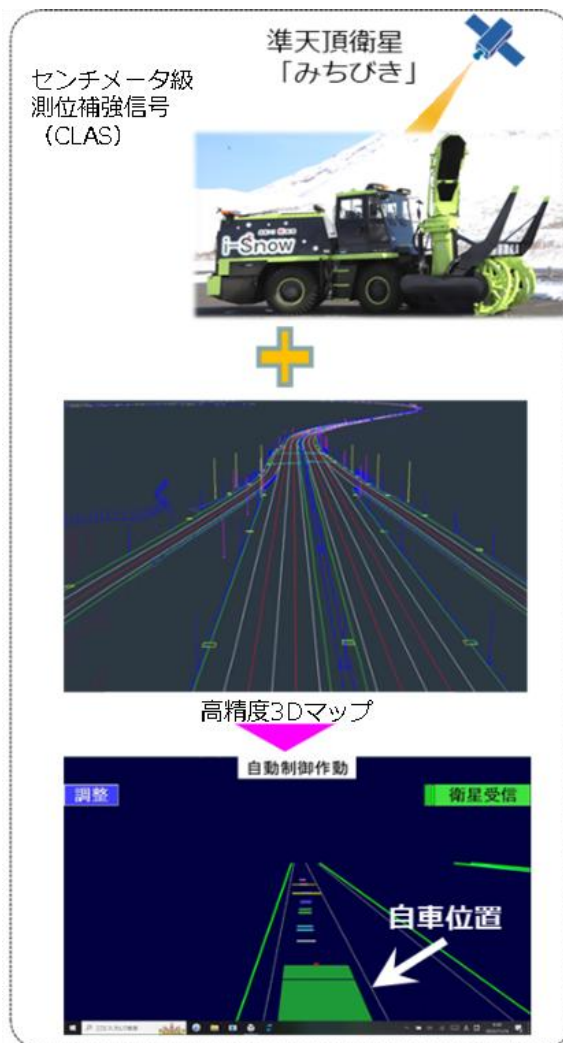
図-5 自動制御システム概要説明
