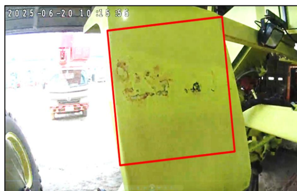
写真-8 後方から見た左側フロントフェンダ腐食部
