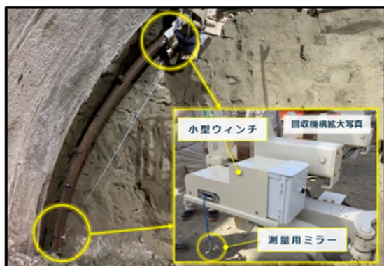
図15 ミラー巻取り機構 概要
