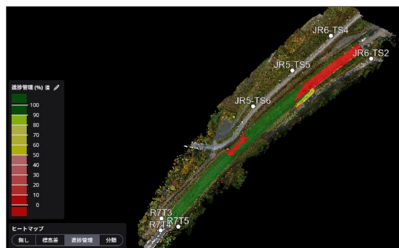
図-5 Smart Construction Dashboard 3) による進捗確認画面
