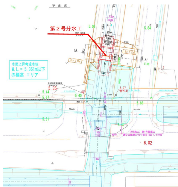
図-10 ゲート設置時の水位上昇 (盛土による溢水対策をした場合)
