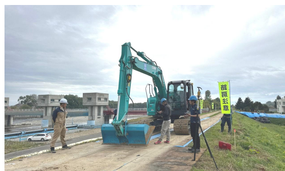
写真5 3Dマシンガイダンスを搭載したバックホウ
