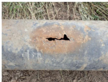
写真-1 管水路腐食状況
