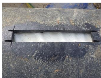
写真-7 疑似孔食を施した供試体
