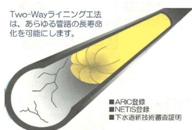
図-4 Two-Way ライニング工法イメージ図
