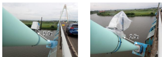
写真-9 斜材ケーブル振動数調査の状況 (左：上段ケーブル、右：下段ケーブル)
