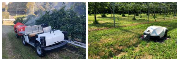
写真-8 左：自動防除機による薬液散布、右：ロボット草刈機
