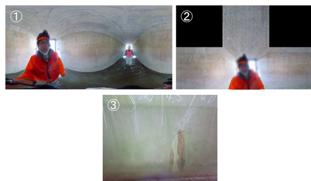
図-7 ①正距円筒動画変換 ②キューブマップ動画変換 ③切り出し画像事例
