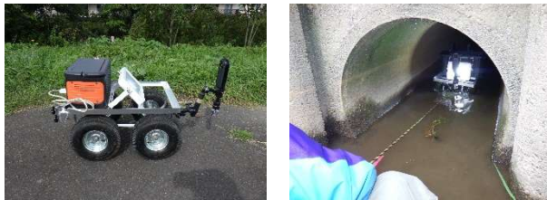
写真-1 樋管における牽引による撮影方法
