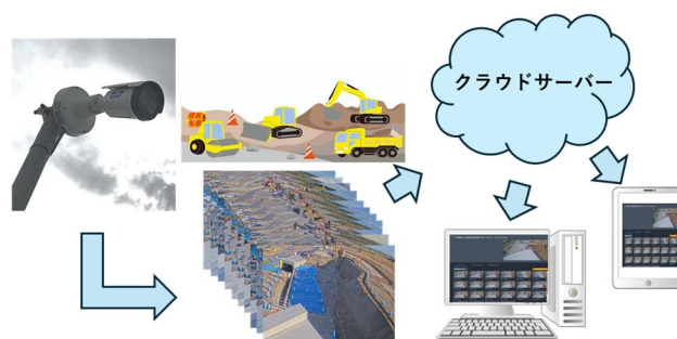
図-5 撮影データとクラウドの仕組み
