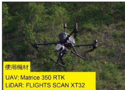
図-1 データ取得に使用したUAV及びLiDAR機器
