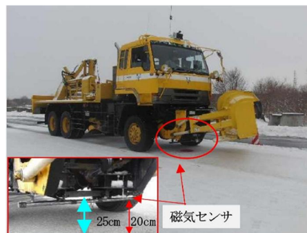
図-2 除雪トラックへの磁気センサの設置状況 (参考文献2から転載)
