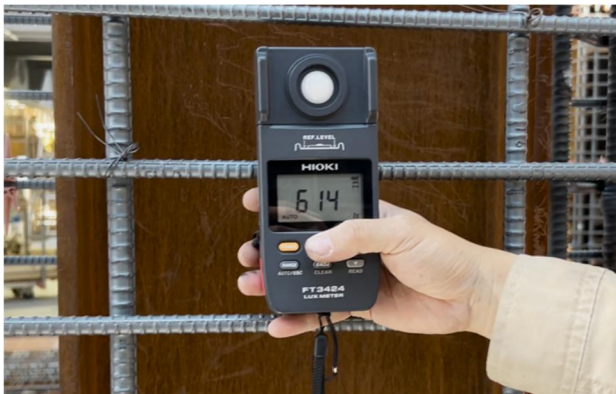
写真-4 照度計による照度測定状況
