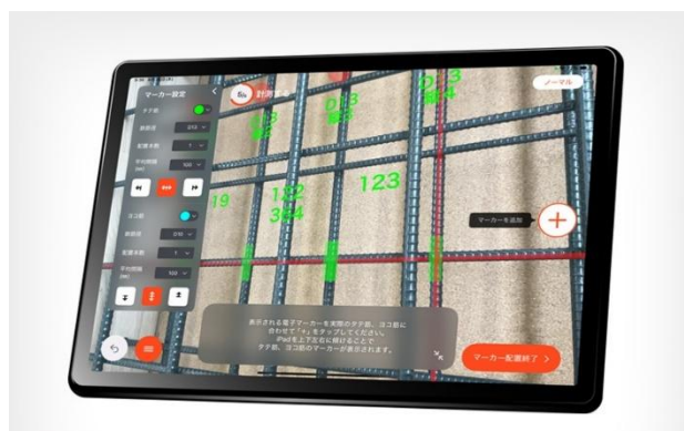
写真-3 配筋検査 AR システム「BAIAS」画面の iPad Pro(参考)
