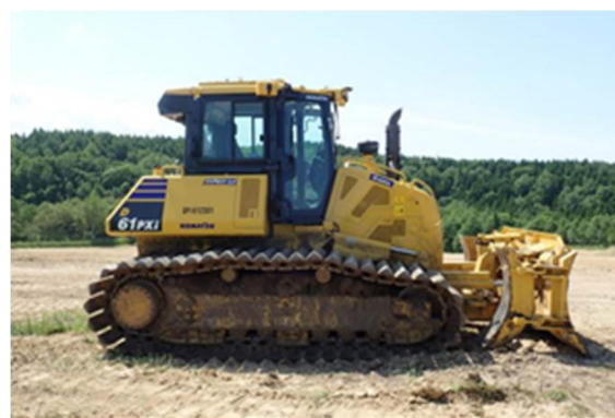
写真-1 表土戻し施工重機：コマツD61PXi
