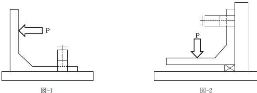
※図-2の試験方法による場合は、縦壁の自重による発生モーメント並びに載荷装置の自重を試験荷重より引くものとする。
