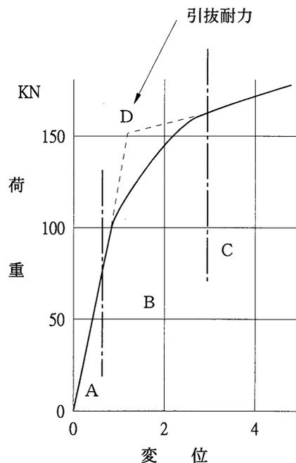
図 4-1 ロックボルト引抜試験
