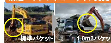
積込バックホウのバケット変更
