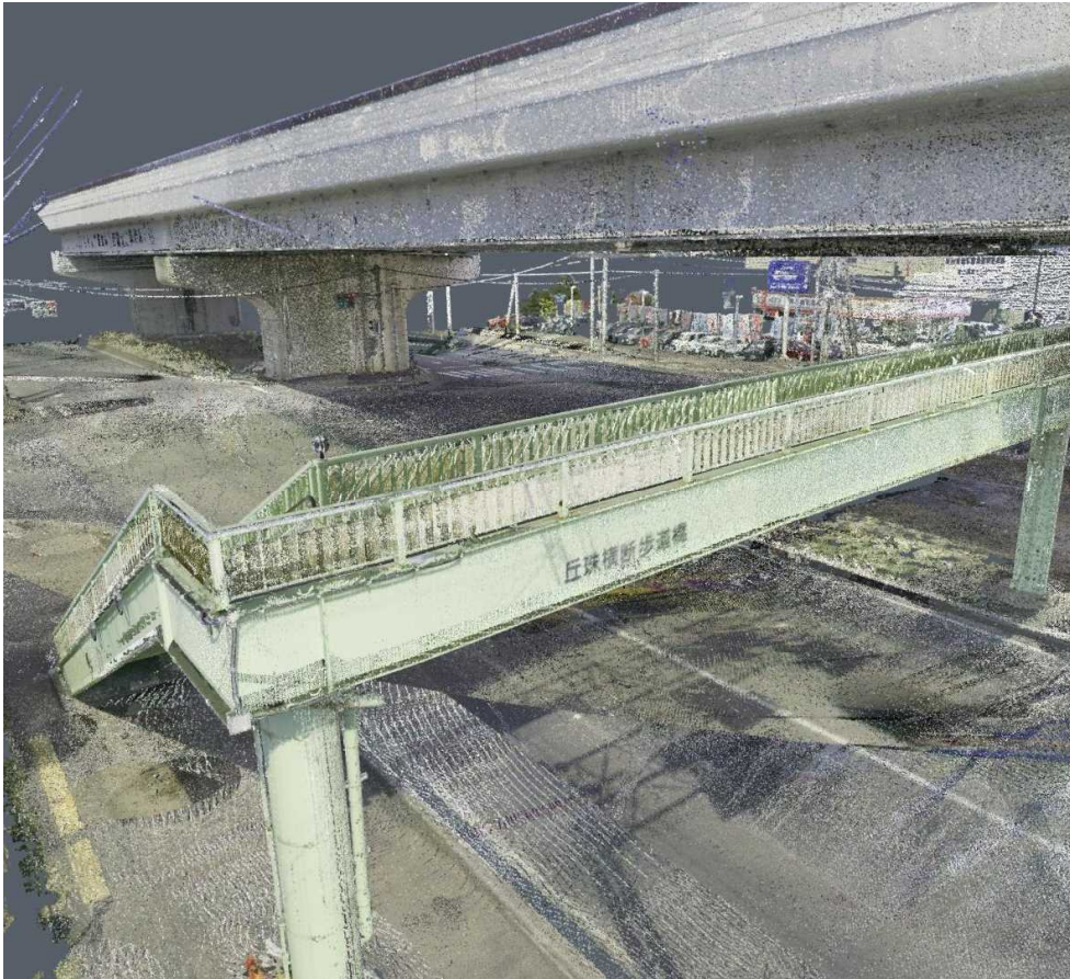
点群データと3Dモデルの重ね合わせ(歩道部)
