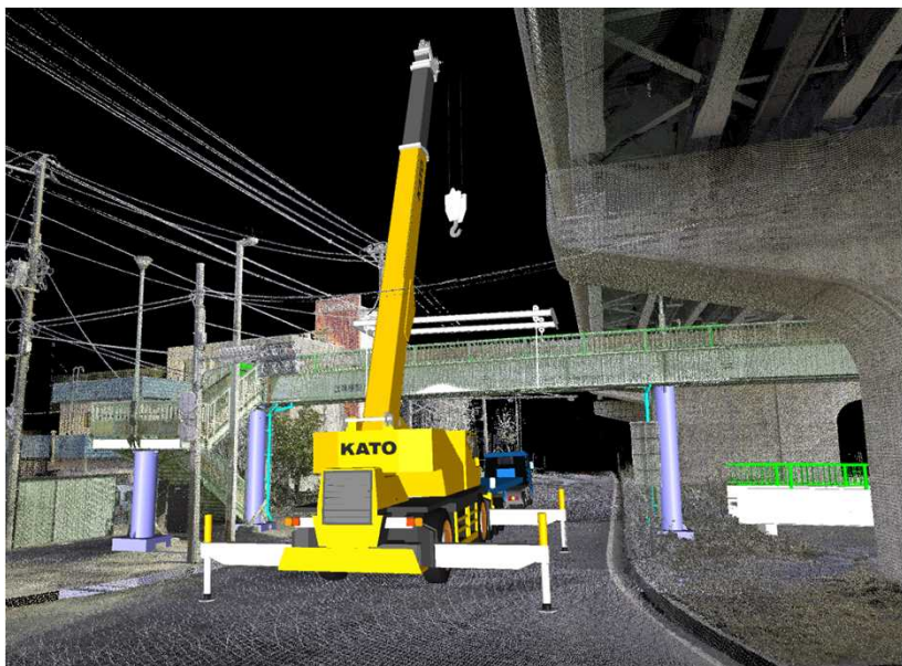
ステップ例<ブロック①②架設>
