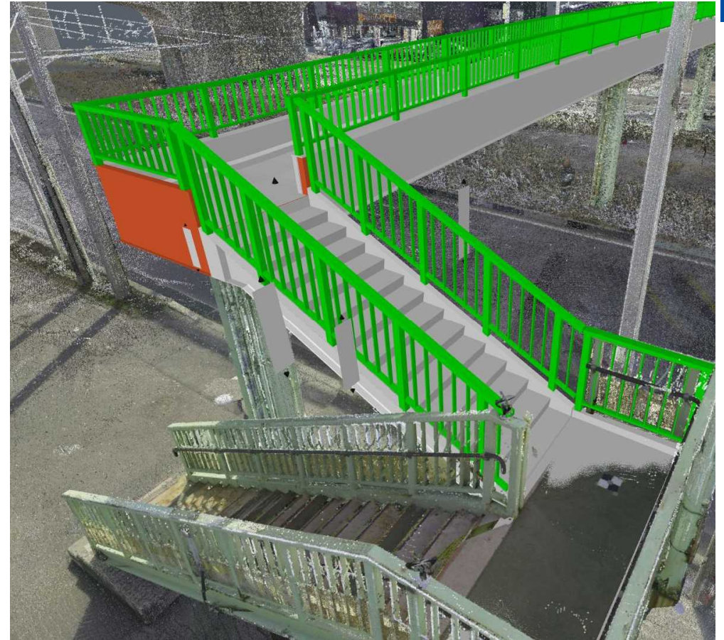
点群データと3Dモデルの重ね合わせ(階段部)
