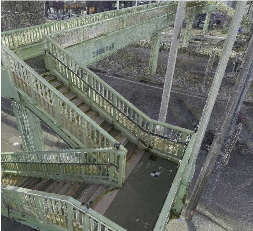
点群データと3Dモデルの重ね合わせ(階段部)
