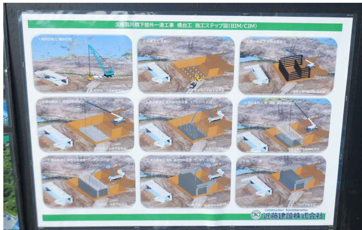
橋台工 施工ステップ図の掲示
