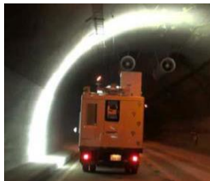
← トンネルの変状写真を撮影する技術 【8技術】
