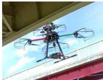
← 橋梁の損傷写真を撮影する技術 【24技術】
