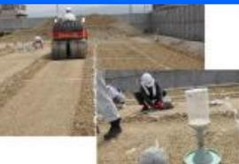
砂置換法による密度試験
