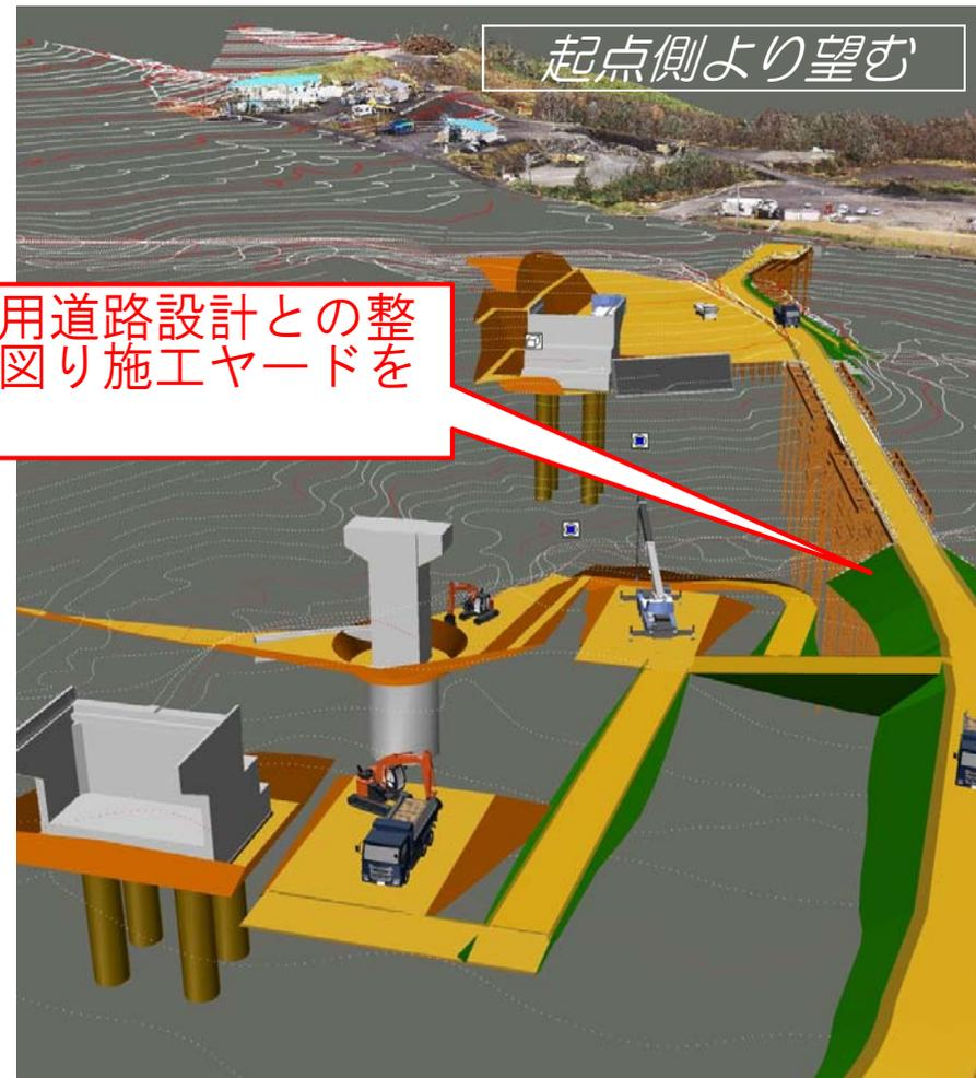
トンネル工事や隣接する橋梁工事など錯綜する現場条件において施工段階毎の重機配置など可視化、立案し、施工工程へ引継ぐことで、効率的な施工が可能
