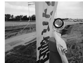
図-4 蓋に取付けたプリズム
