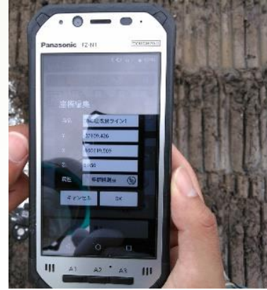
快速ナビによるワンマン測量。(sim)
