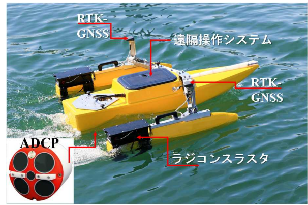
図-8 ラジコン式 ADCP の概要
