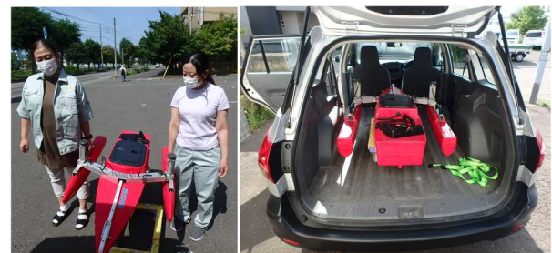
図-10 ラジコン式 ADCP の運搬と収納
