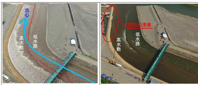
写真-2 堤防侵食前後（左右）の実験水路の比較
