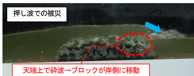
写真6 波浪種類ごとのブロックの被災状況 (上段：ケース2-1-3, 下段：ケース2-1-4)
