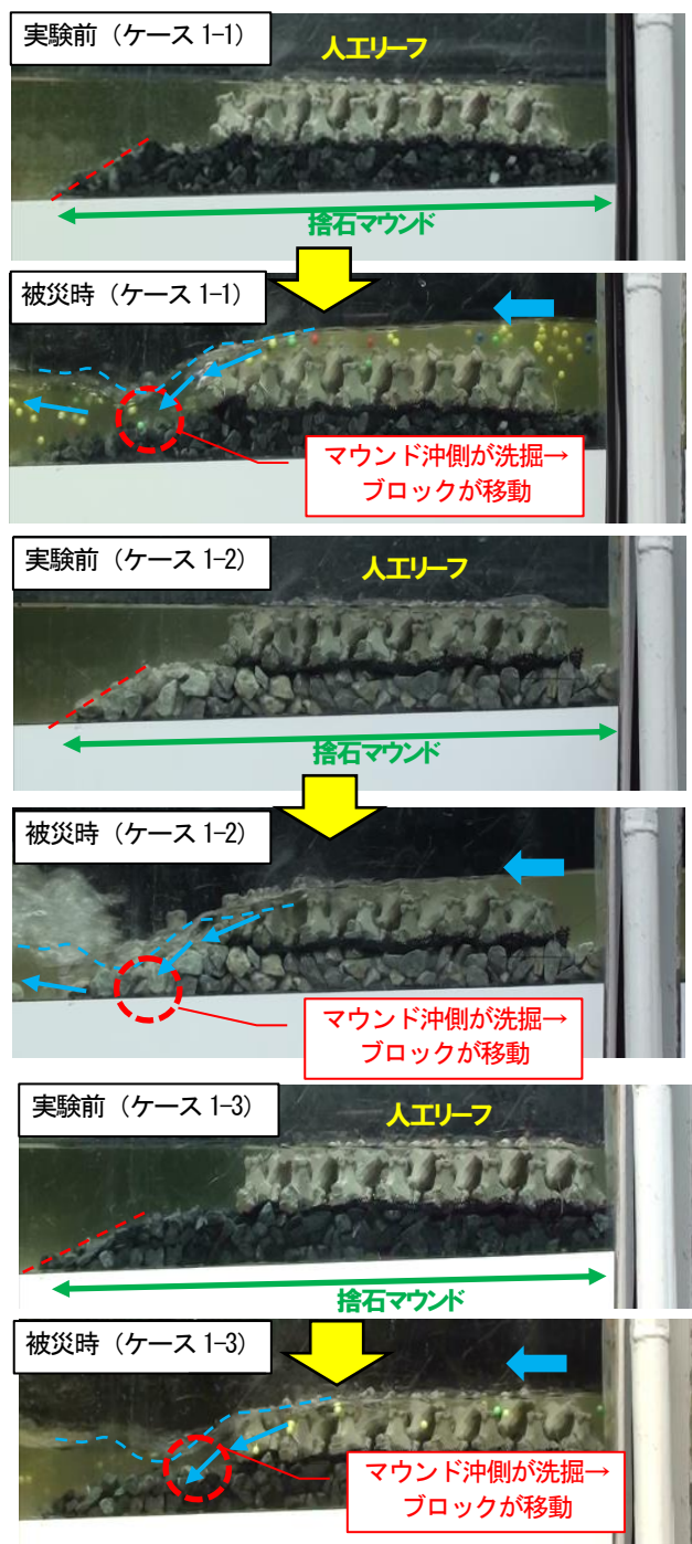
写真-4 高天端人工リーフの捨石マウンドの被災過程
