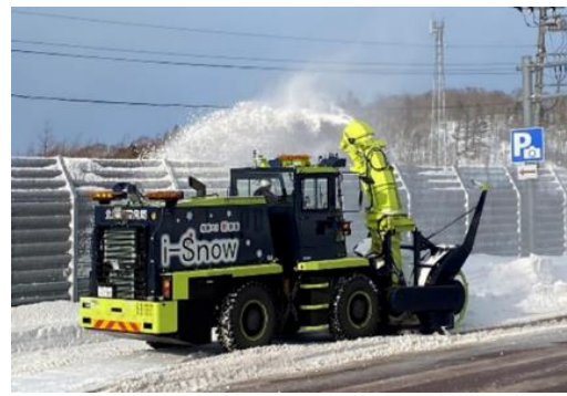
写真-3 道路附属物等の障害物を避けた投雪作業
