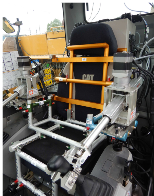
写真-3 簡易遠隔操縦装置「ロボQS」取付状況
