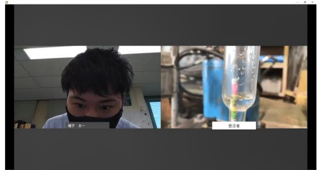
図-4 バッテリー比重確認時
