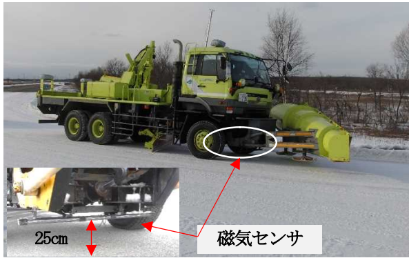
図4 磁気センサ設置状況
