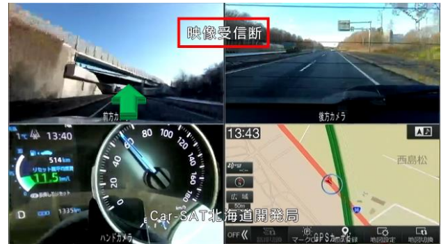
図-12 衛星通信が切断されたときの映像 (矢印は衛星の方向を示す)
