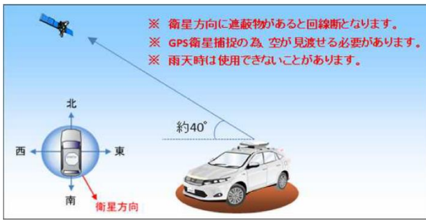
図-11 Car-SAT システムの衛星通信条件
