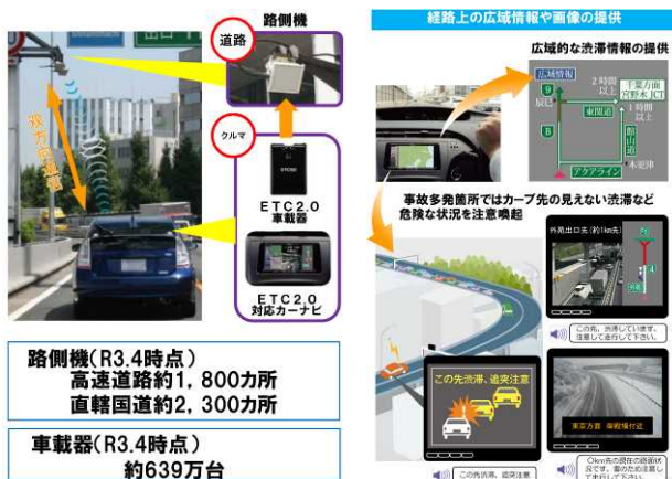
図-1 ETC2.0の仕組み
