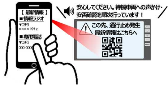
図-12 ETC2.0を活用した立ち往生車両への情報提供イメージ
