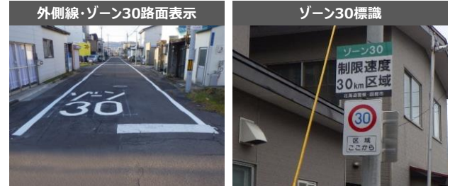
写真-1 生活道路対策エリアで実施された対策例（函館市上新川地区で実施した事例）
