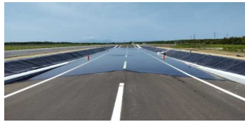
写真-1 路面冠水実験路（冠水時）
