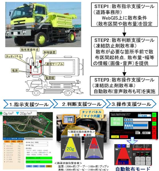
図-6 凍結防止剤散布支援システム (AIS3) の概要
