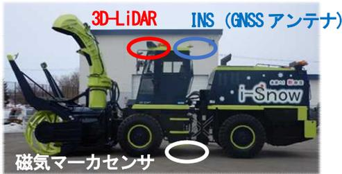
図-12 「i-Snow」ロータリ除雪車への不感地帯対策技術の設置状況
