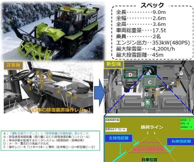
図-5 i-Snowロータリ除雪車の概要
