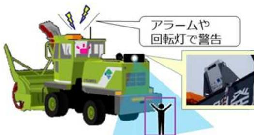
図-8 3DカメラとAI物体認証を有した接触防止システム
