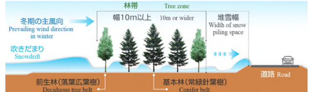
図-2 標準的な防雪林における堆雪状況横断面図
