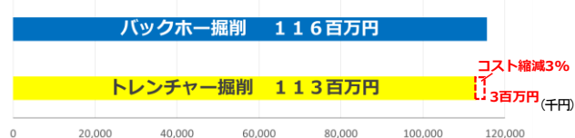
図-12 トレンチャーを活用し電線共同溝を建設した場合の直接工事費（1kmあたり）の比較（試算値）
