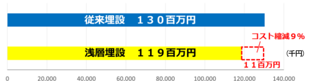
図-10 美深町で浅層埋設を行い電線共同溝を建設した場合の直接工事費（1kmあたり）の比較（試算値）
