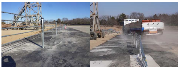
写真-1 ワイヤロープ式防護柵(左)と性能確認試験(右) 2)
