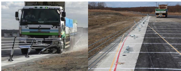
写真-10 衝突試験(2020)状況 (左: 衝突時、右: 衝突後)
