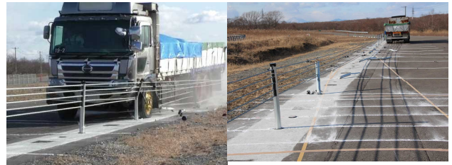
写真-5 衝突試験(2019)状況（左：衝突時、右：衝突後）
