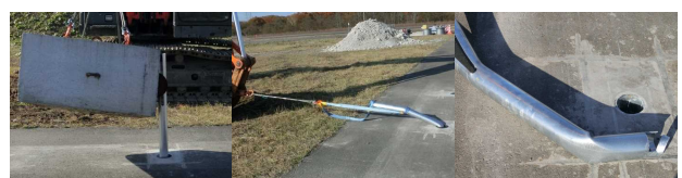
写真-3 下部切欠き支柱と短尺スリーブの試験状況
