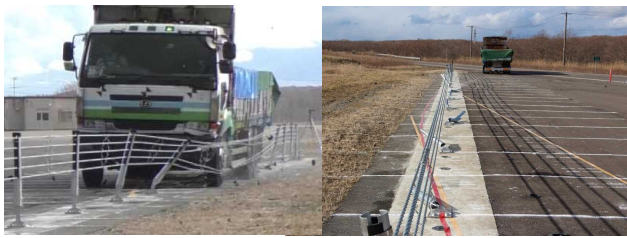
写真-13 衝突試験(2021)状況 (左:衝突時、右:衝突後)
