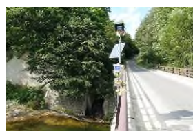
写真-8 橋梁傾斜状況の遠隔監視
