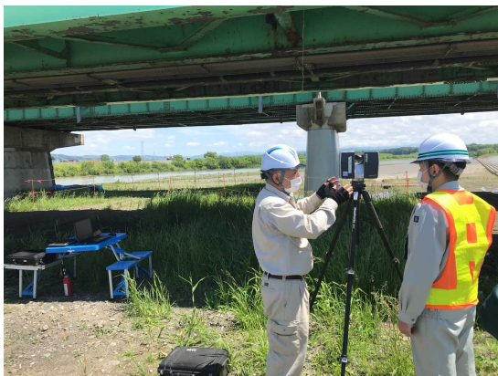
写真-1 地上型3Dレーザースキャナー (点群データ取得)
