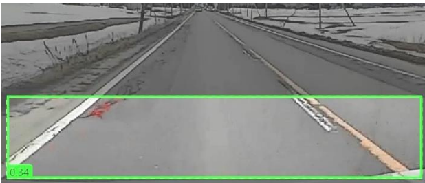
図-6 検出漏れの例(偽陰性、ポットホールを見落とし)
