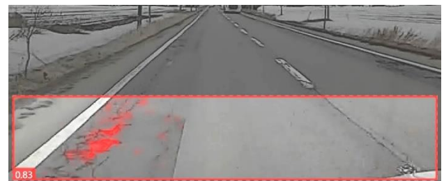
図-4 正検出の例(真陽性、ポットホールを検出できている)
