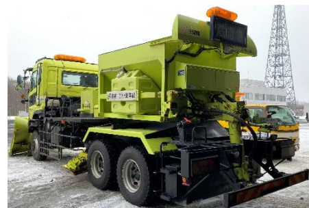
写真-2 凍結防止剤自動散布システムを搭載した除雪トラック(散布装置付き)
