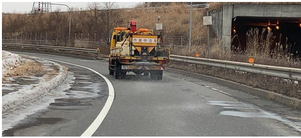
写真-1 検証状況(国道におけるワンマン化での自動散布)
