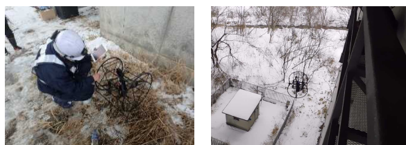
図-14 二輪型マルチコプタ作業状況
