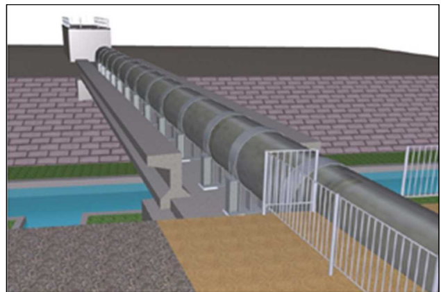
図-3 パイプインフルーム工法（イメージ図）
