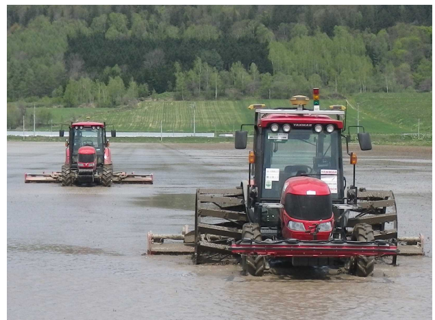
写真-6 2台のロボットトラクターによる協調作業(実証試験)
