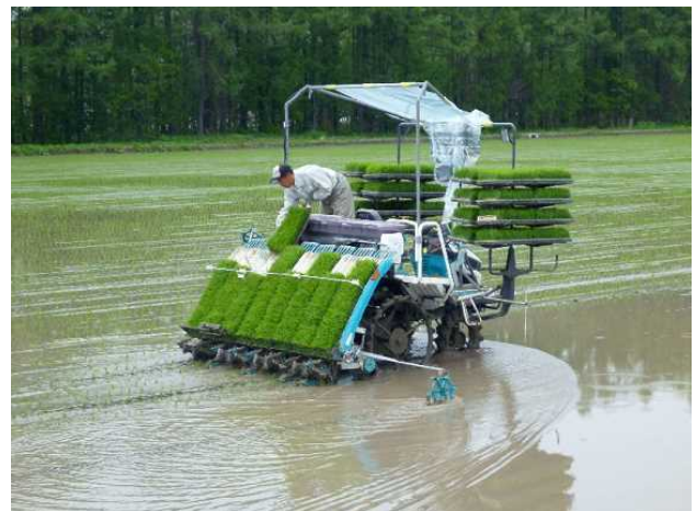
写真-5 GPSオートステアリング田植機
